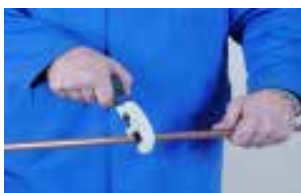
1.- Corte de tubo 1.- Cortar o tubo
