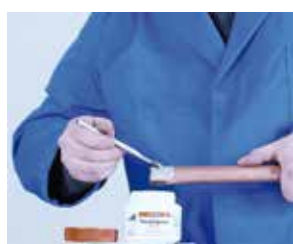
4. Aplicación del decapante 4. Aplicação do decapante
