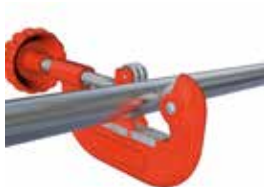
1. Corte de tubo 1. Cortar o tubo
