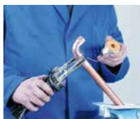
5. Aplicación de la soldadura 5. Aplicação da soldadura
